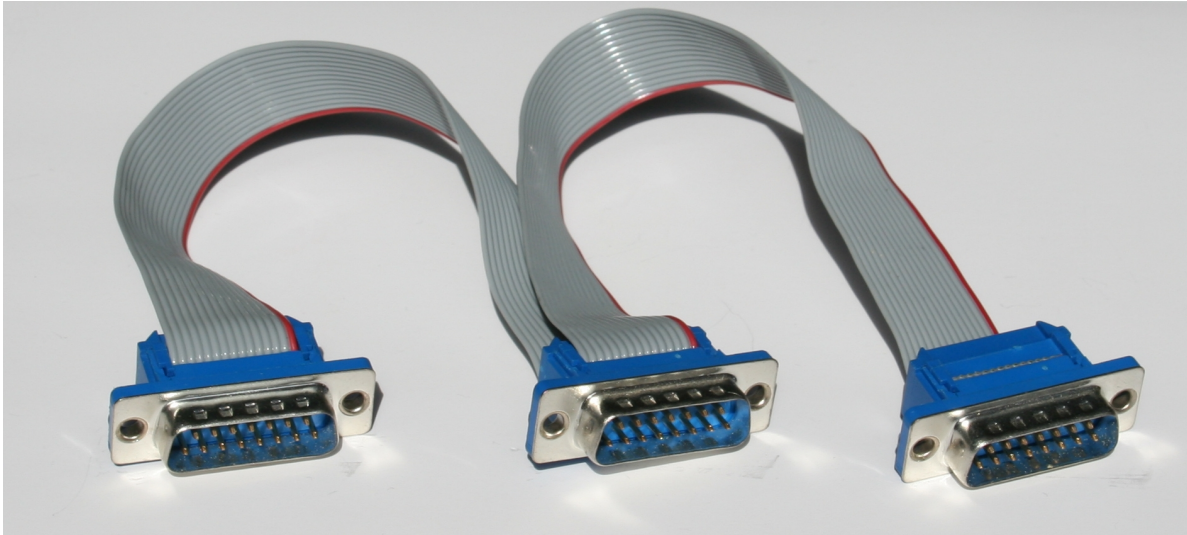
Abbildung 3.58: SXL II - I 2 C System-Bus Kabel
